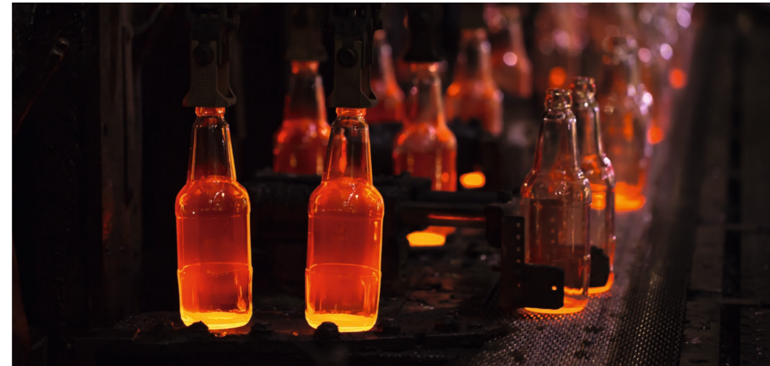
Glas wird bei ca. 1.100 °C geschmolzen und verarbeitet, was sehr viel Energie erfordert
