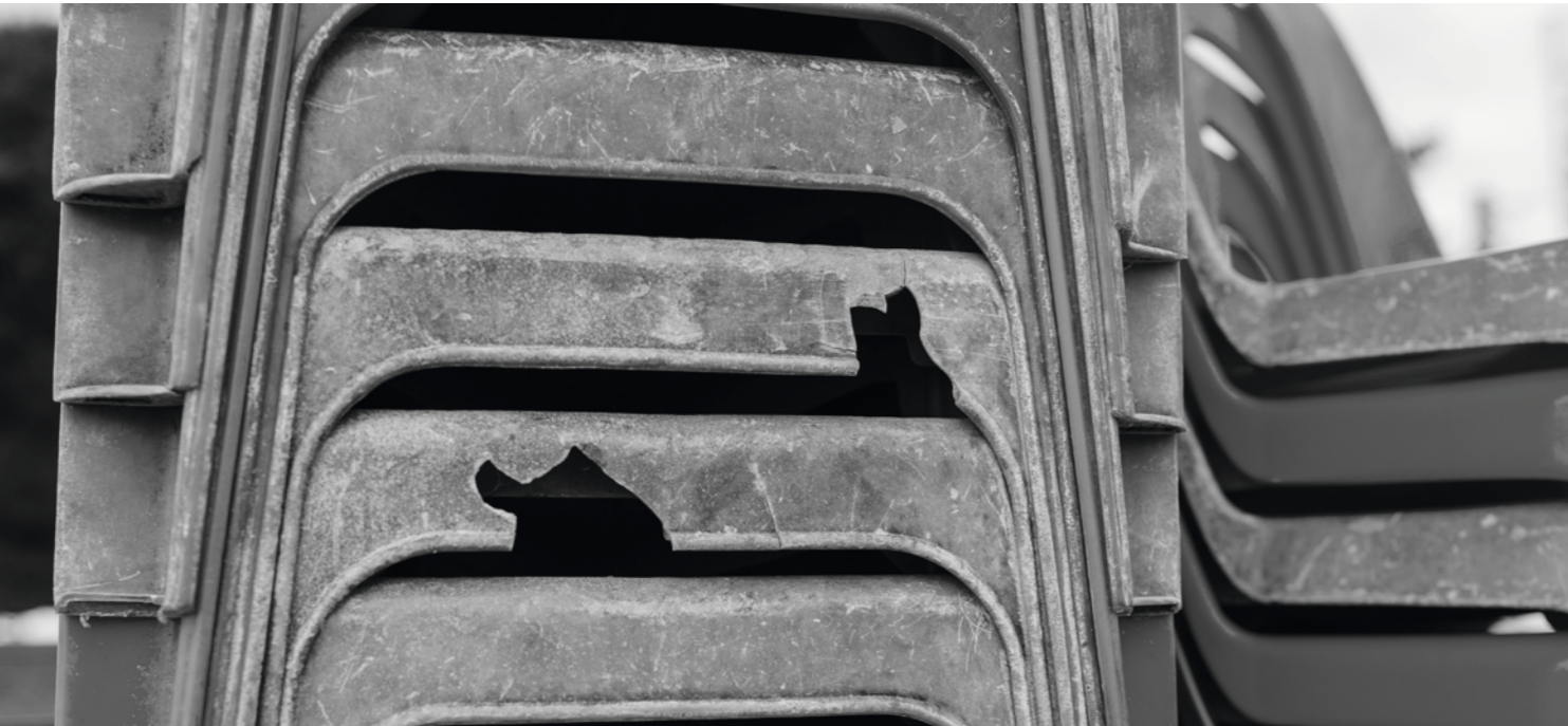
Durch Sonnenstrahlung stark angegriffene Gartenstühle aus Polypropylen
