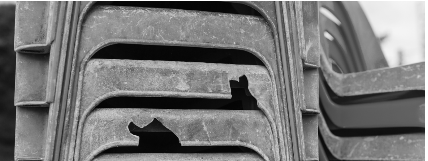
Chaises de jardin en polypropylène fortement dégradées par le soleil
